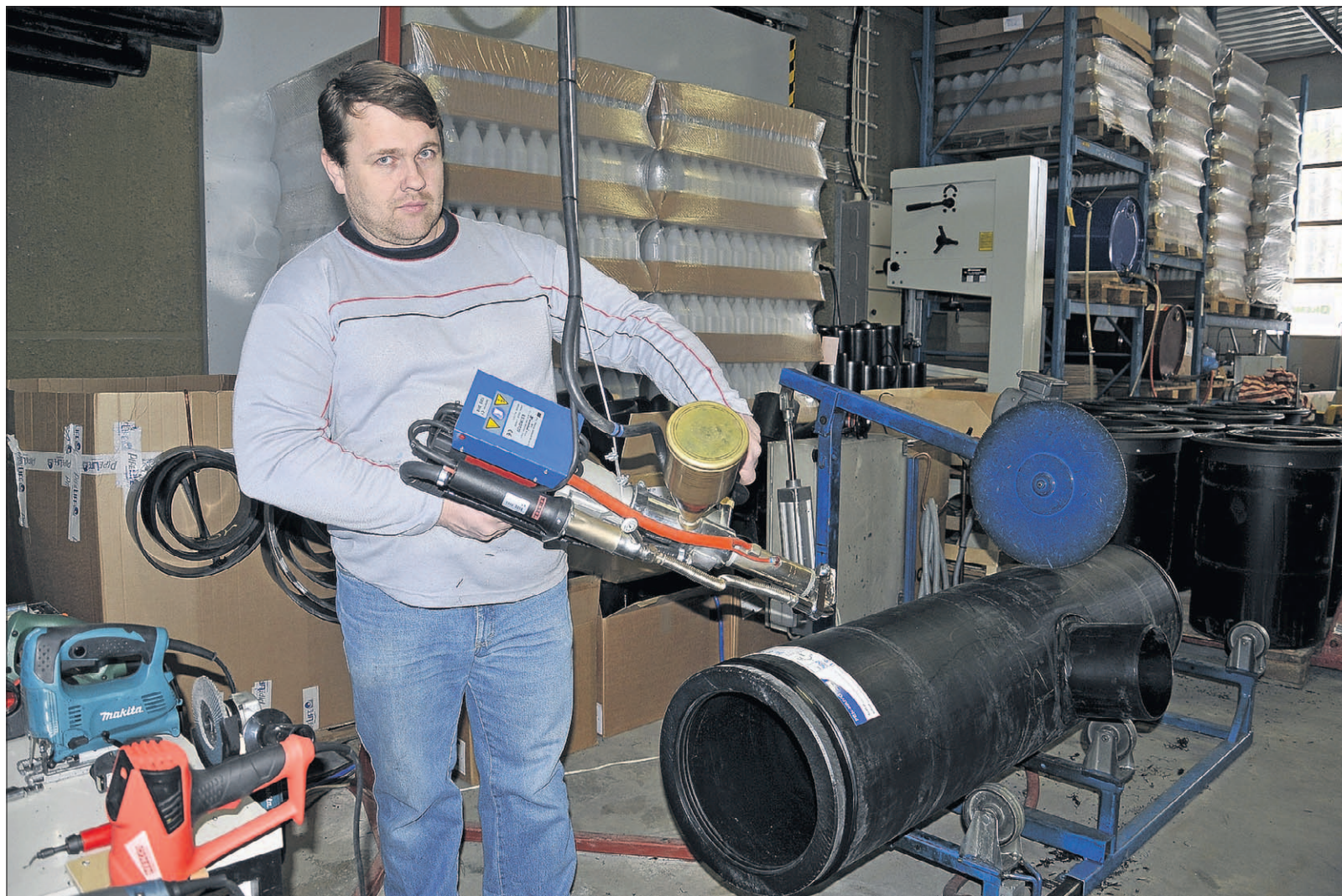
Jorma Korpela esittelee muovinhitsauslaitetta, jolla osia voidaan liittää vankasti yhteen.
